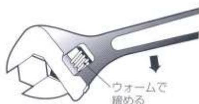
◆ボルト・ナットを回す時には、必ずモンキレンチをボルト・ナットに直角の形で、平行に回して下さい。(図2参照)
