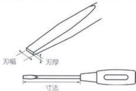
◆寸法は主として、軸のつけ根から先端までの長さで呼びます。また、それに先端部の刃幅を組合わせて呼ぶこともあります。この長さと刃幅はJIS規格で決まっていますので、締め付けるねじによく合うものを選ぶことが大切です。長さと刃幅の関係は表1の通りとなっています。
