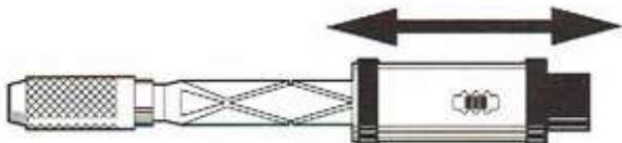
押し付けたハンドルが戻る時は、刃先は空回ります。本体に組み込まれた駒とスパイラル溝が噛みあって回りますので、回り方も早く能率的です。刃先はねじに合った大きさのものを、差し替えて使うようになっています。
