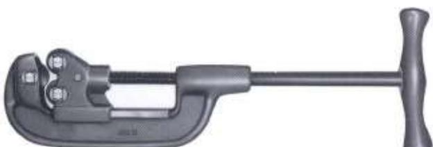
切断しようとするパイプを受ローラーとカッタホイールの間にに入れ、ハンドルを回して挟み込み、最初は軽く案内溝を作る程度に締め付けて、パイプ周りにパイプカッタを回転させ、パイプ外周に正しく案内溝がついたか確認してから、ハンドルを回しながらパイプカッタを回していきます。
