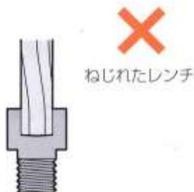
7. ボルトの回転方向に力を加えて下さい。ねじる方向ではなく、ソケットの軸方向を倒す方向へ力を加えると、ソケットが破損する時があります。
